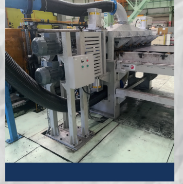
ERSEM 07/2019 SICAK MAKAS TOZ TOPLAMA SİSTEMİ
