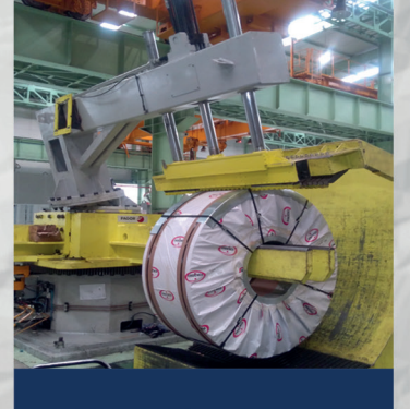
ERSEM 07/2018 SICAK DİLME PİYANO SİSTEMİ
