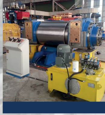
TEZCAN GALVANİZ 08/2016 HADDE DESTEK VE İŞ MERD.DEĞ.SİST.
